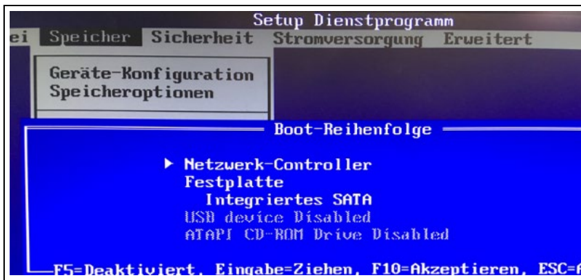
Abb. 2: Konfiguration der Boot-Reihenfolge an einem HP-Client-PC
