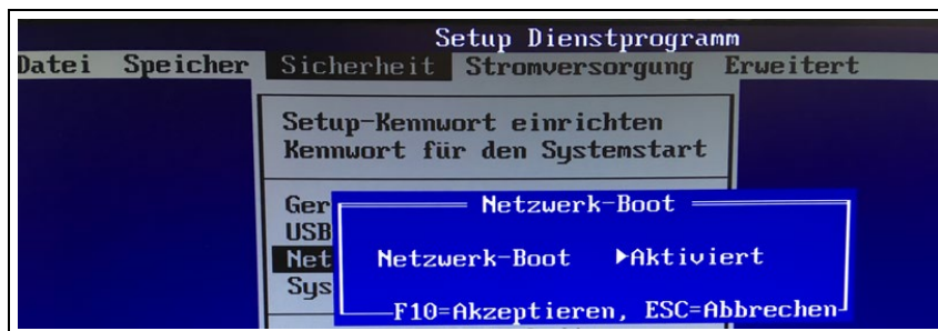
Abb. 1: Aktivierung der PXE-Unterstützung an einem HP-Client-PC
